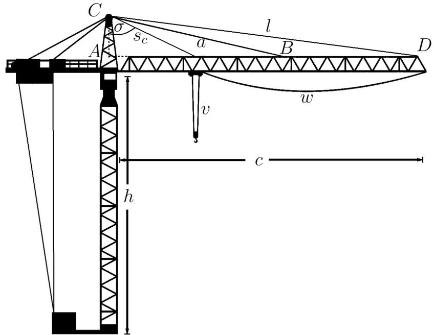
b) Bestimme die Länge des Auslegers  $g = \overline{AD}$ . Das Dreiecks  $\triangle CBD$  besitzt einen Winkel  $\delta$  am Punkt  $D$  von  $6,5727^\circ$ .
