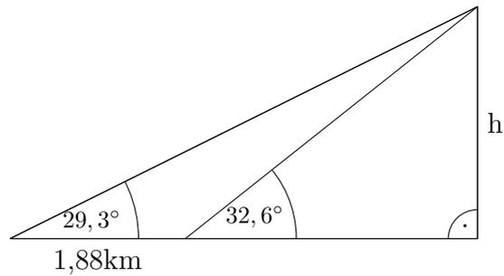
**Aufgabe 5:** Eine Autobahnbrücke soll über ein Flusstal gebaut werden. Nach einer neuen Verordnung darf eine Autobahn nicht mehr als 5% Steigung aufweisen. Die Ingenieure haben eine vereinfachte Skizze mit den bekannten Werten erstellt. Wie lang ist die Autobahnbrücke und darf sie gebaut werden?
