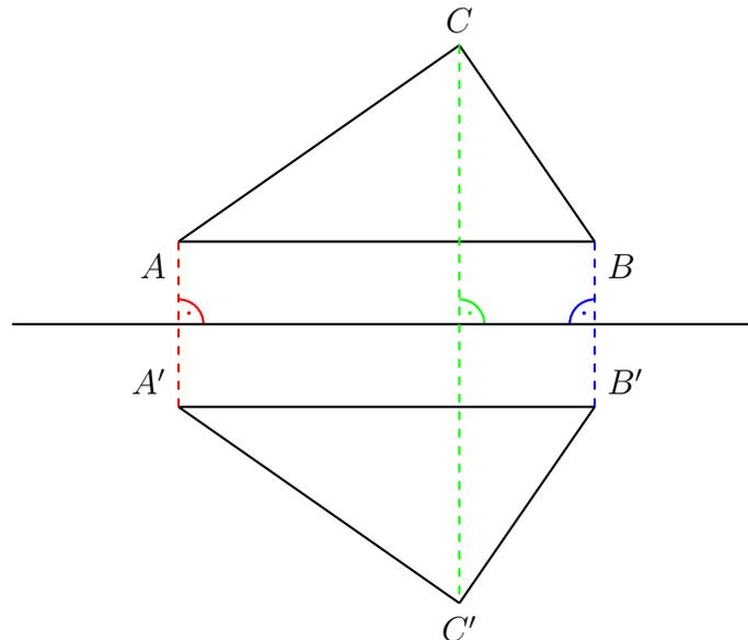
In der Abbildung ist zu erkennen wie eine solche *Achsen Spiegelung* aussieht. Hierbei zeigen die gestrichelten Linien, dass die *Abstände* zwischen den *Eckpunkten* ( $A$ ,  $B$  und  $C$ ) und der *Achse* genauso lang sind wie die *Abstände* der *Spiegelecke* ( $A'$ ,  $B'$  und  $C'$ ) zur *Spiegelachse*. Dabei meint *Abstand* immer die kürzeste *Strecke* zwischen *Punkt* und *Achse*, was immer die *orthogonale Strecke* zur *Achse* ist.
