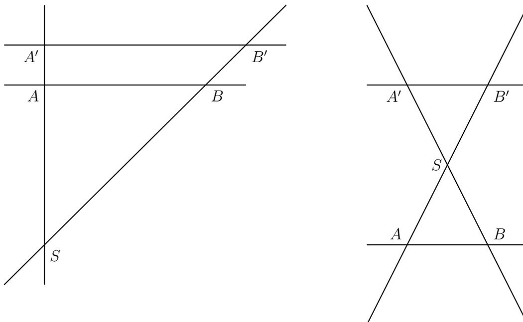
Die Abbildung veranschaulicht diese Bedingung auf die zwei möglichen Arten. Deutlich zu erkennen ist, dass dabei die *parallelen Geraden* auf einer Seite des *Schnittpunktes* oder auf unterschiedlichen Seiten befinden dürfen. Hierbei können Verhältnisse zwischen den jeweiligen *Strecken* aufgestellt werden. So verhält sich  $\overline{AB}$  zu  $\overline{A'B'}$  wie  $\overline{AS}$  zu  $\overline{A'S}$ . Es gibt noch weitere solche Beziehungen, darunter auch diese:
