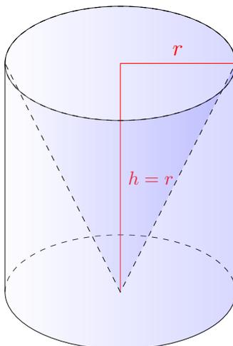
Da wie bereits anhand von *Pyramiden* und *Quadern* gezeigt, passen drei der *Kegel* aus der Abbildung in den *Zylinder*. Somit ist das *Volumen* einer *Halbkugel* gegeben als  $\frac{2}{3}\pi r^3$  und folglich, dass einer *Kugel* durch:
