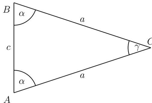
Das *Geodreieck* ist ein solches *gleichschenkliges Dreieck*. Durch die Bestimmung eines *Winkels* sind alle *Winkel* bekannt - Diese Eigenschaft kann in vielen Aufgaben ausgenutzt werden. Des Weiteren gibt es noch den Spezialfall, dass alle *Seiten* des *Dreiecks* gleich lang und alle *Winkel* gleich groß sind - das *gleichseitige Dreieck*. Damit ergibt sich automatisch, dass jeder *Winkel* exakt  $60^\circ$  messen muss.
