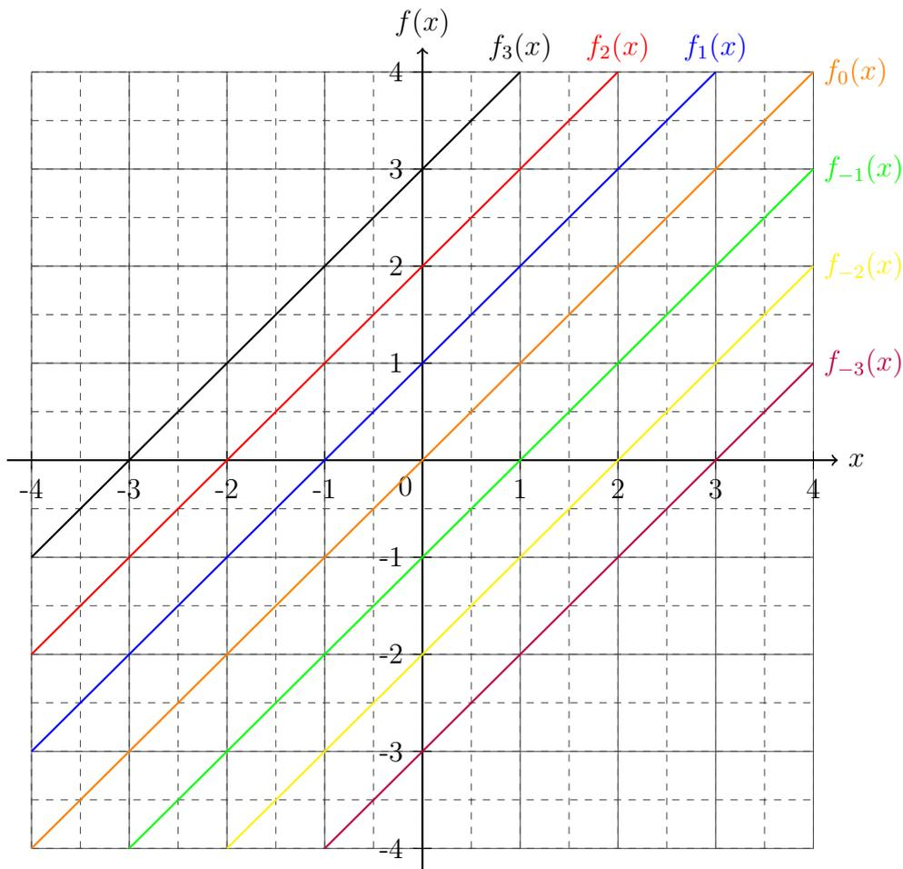
Im *Koordinatensystem* ist deutlich zu erkennen, dass der Wert von  $b$  mit dem Wert der *Ordinate* übereinstimmt, wenn sich *Ordinate* und die *Gerade* treffen, somit wird  $b$  auch der *Ordinaten-schnittwert* oder *Offset* der *Funktion* genannt.
