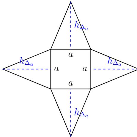
Wie das *Netz* schon vermuten lässt, wird die *Höhe* der *Dreiecke*  $h_{\Delta_a}$  benötigt. Diese kann über den *Satz des Pythagoras* bestimmt werden (siehe dazu die *Abbildung* der *Pyramide*):
