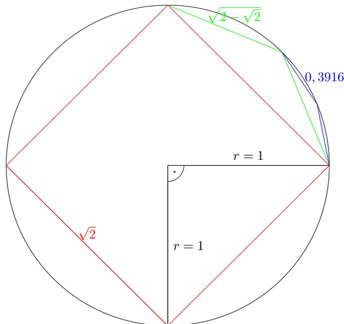
Die Abbildung zeigt genau dieses Verfahren. Wenn diese Prozedur oft genug wiederholt wurde, soll der *Umfang* des eckigen Körpers und auch der *Flächeninhalt* bestimmt werden. Dies wird nun im Weiteren schrittweise geschehen.
