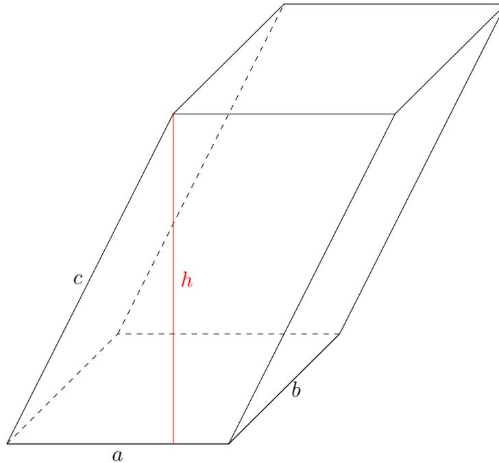
Da die *Winkel* im Verhältnis zu einander kleiner und größer geworden sind, wird das *Volumen* durch die *Höhe*  $h$  limitiert. Generell gilt für jeden Körper zur Berechnung des *Volumens* immer „*Grundseite* mal *Höhe*“. Somit ist es völlig ausreichend einen Körper zu unterteilen in *Teilkörper*, die berechnet werden können.
