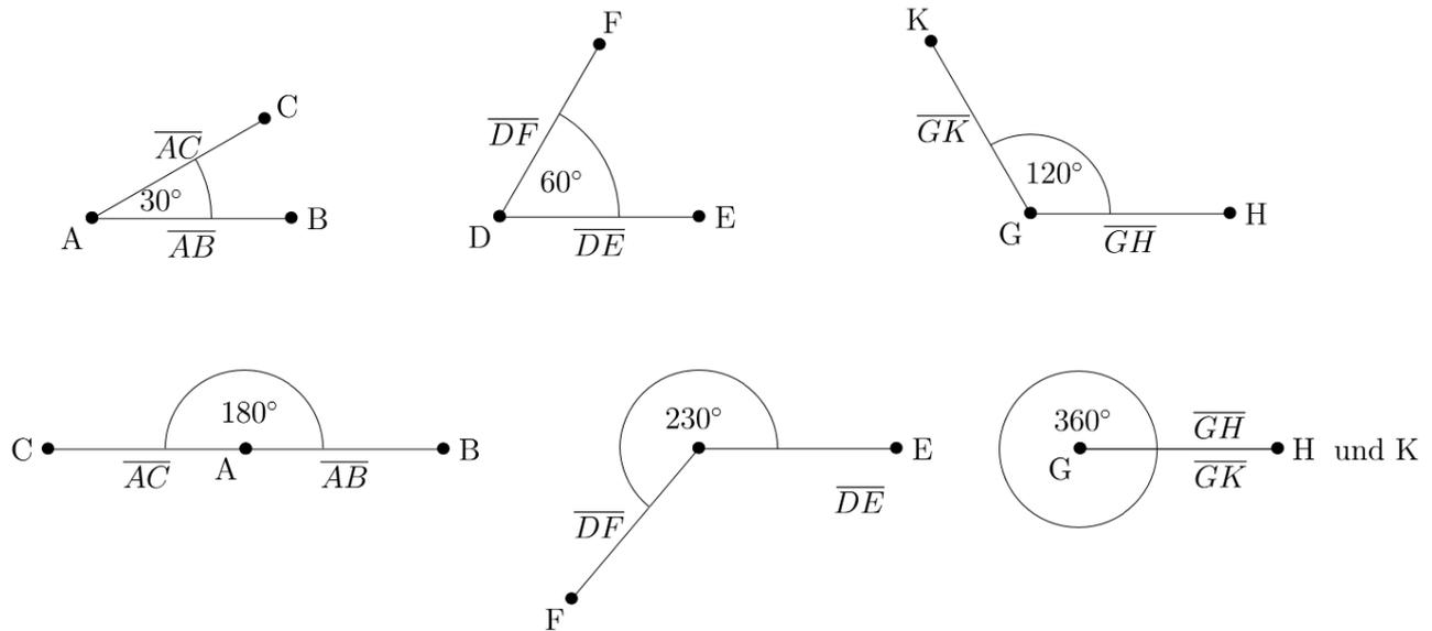
Wobei ein Winkel von  $180^\circ$  *gestreckter Winkel* genannt wird ( $\angle((\overline{AB}, \overline{AC})) = 180^\circ$ ). Bei Winkeln zwischen  $180^\circ$  und  $360^\circ$  ist die Rede von einem *überstumpfen Winkel* ( $180^\circ < \angle((\overline{DE}, \overline{DF})) < 360^\circ$ ). Abschließend existiert noch ein Winkel von  $360^\circ$ , welcher als *voller Winkel* bezeichnet wird ( $\angle((\overline{GH}, \overline{GK})) = 360^\circ$ ).
