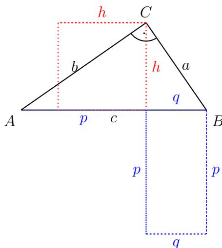
Die Abbildung zeigt, dass die *Flächeninhalte* aus dem *Quadrat*, welches durch die *Höhe*  $h$  mit sich selbst aufgespannt wird, mit dem *Rechteck* aus der unterteilten *Hypotenuse* aus  $p$  und  $q$  in Verbindung gebracht werden. Es gilt:
