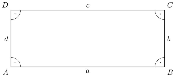
Die Abbildung zeigt, wie die *Seiten* und die *Eckpunkte* eines *Rechtecks* benannt werden. Es gilt, wie bereits erwähnt, dass  $\overline{AB} = a = c = \overline{CD}$  und  $\overline{BC} = b = d = \overline{DA}$ . Die *Strecken*  $\overline{DB}$  und  $\overline{AC}$  werden *Diagonalen* genannt.
