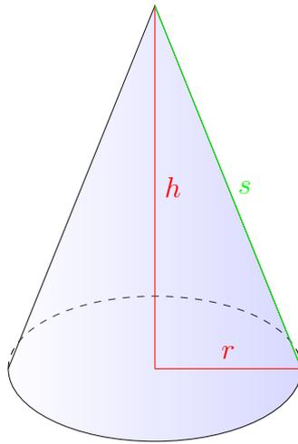
Der *Kegel* ist im Vergleich zum *Zylinder* genauso zu handhaben wie die *Pyramide* im Vergleich zum *Quader*. Somit ergibt sich das *Volumen* des *Kegels*  $V$  als ein Drittel des *Volumens* eines *Zylinders*. Bei der *Oberfläche* ist dies nicht so trivial, denn ein *Kreis* als *Grundfläche* wird mit einem *Kreisausschnitt* addiert. Dabei hat der *Kreisausschnitt* den *Radius*  $s$  und eine *Kreisbogenlänge*  $b = 2\pi r$ .
