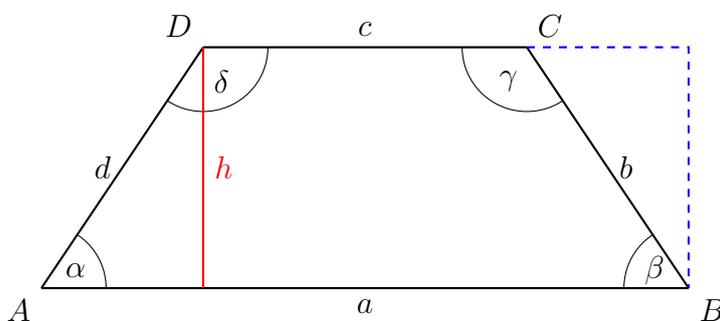
Die Abbildung zeigt ein *Trapez* bei dem die *Winkel*  $\delta$  und  $\gamma$  sowie  $\alpha$  und  $\beta$  gleich groß und aus diesem Grund auch die *Seiten*  $d$  und  $b$  gleich lang sind. Auch zeigt die Abbildung wie aus einem solchen *Trapez* wieder ein *Rechteck* gewonnen werden kann. Dabei wären die *Seiten* dieses *Rechtecks* gegeben durch die *Höhe*  $h$  und dem *Mittelwert*  $m$  der *Summe* von  $a$  und  $c$ . Hierbei gilt  $m = \frac{a+c}{2}$  und somit:
