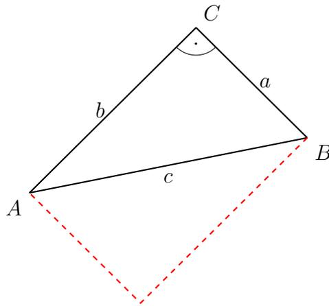
Die Abbildung zeigt die Benennung der *Größen* eines *rechtwinkligen Dreiecks*. Da das *Dreieck* aus dem Zerschneiden eines *Rechtecks* in zwei Teile gewonnen wurde, ist die *Winkelsumme* eines *Dreiecks* gegeben als  $180^\circ$ . Allerdings müssen nicht alle *Dreiecke* einen *rechten Winkel* besitzen, sodass auch die *Winkel* benannt werden müssen.
