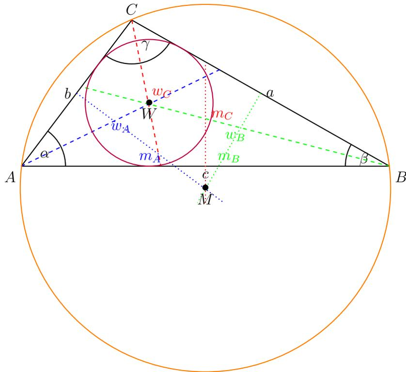
In der Abbildung sind die *Winkelhalbierenden*  $w$  gestrichelt und die *Mittelsenkrechten*  $m$  gepunktet. Dabei sind alle Linien die vom *Punkt A* ausgehen blau, alle Linien die vom *Punkt B* ausgehen grün und alle Linien die vom *Punkt C* ausgehen rot gehalten. Der *Innenkreis* ist in einem dunklen violett gehalten und hat seinen *Mittelpunkt* beim *Punkt W*, während der *Umkreis* ist in orange gezeichnet wurde und seinen *Mittelpunkt* beim *Punkt M* hat.
