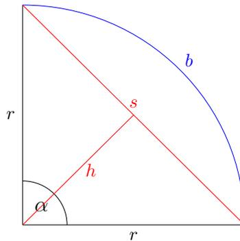
Die Abbildung zeigt einen *Kreisausschnitt* mit allen Unterteilungen für einen *Kreisabschnitt* sowie den *Kreisbogen*. Dabei ist der *Kreisbogen*  $b$  ein *Bruchteil* des *Umfangs*, der durch  $2\pi r$  und  $360^\circ$  beschrieben wird. Somit ergibt sich, dass für einen *Winkel*  $\alpha$  folgende *Bogenlänge*  $b$  ergibt:
