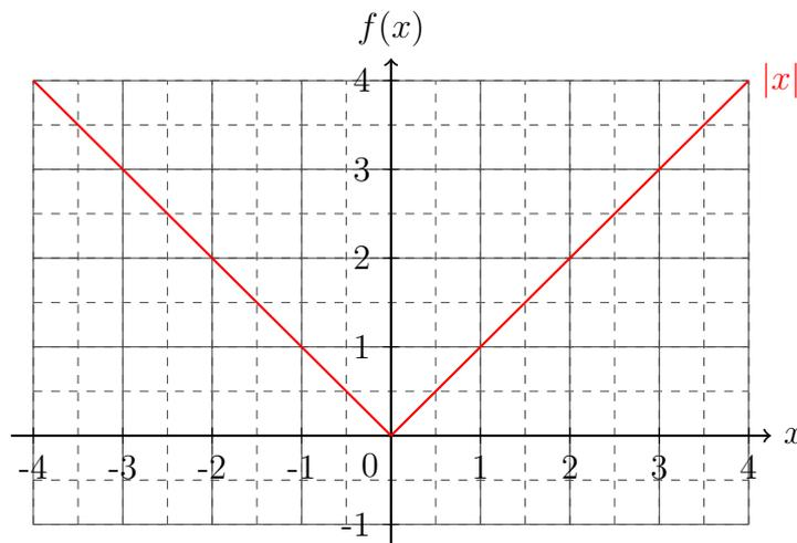
An der Abbildung ist zu erkennen, dass die *Betragsfunktion* einen Knick im *Koordinatenursprung* besitzt und dass die *Funktion* *achsensymmetrisch* bezüglich der *Ordinate* ist. Die *Achse* der *Symmetrie* sowie der Knick der *Funktion* kann verschoben werden, indem in den *Betragsstrichen* eine Zahl *addiert* wird.
