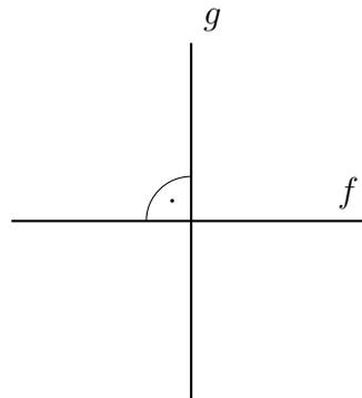
Die Abbildung zeigt einen *rechten Winkel* zwischen der *Gerade*  $f$  und  $g$ :  $\sphericalangle(f, g) = 90^\circ$ . Die Eigenschaft, dass *Strecken* und/oder *Geraden* einen *rechten Winkel* zu einander haben, wird *Orthogonalität* genannt. Es wird davon gesprochen, dass zum Beispiel zwei *Geraden orthogonal* zu einander sind (oft wird auch der Begriff „senkrecht“ verwendet). Abkürzend wird die *Orthogonalität* der *Strecken* und *Geraden* in den Beispielen so ausgedrückt:
