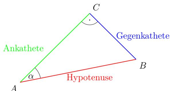
Wie die Abbildung zeigt, werden dann die *Seiten* im Bezug auf den *Winkel*  $\alpha$  benannt. Dabei ist die *Ankathete* immer die *Kathete* des *rechtwinkligen Dreiecks*, welche sich am zu untersuchenden *Winkel* befindet. Nun wird ein Verhältnis aufgestellt, *definiert* und mit einem Namen versehen:
